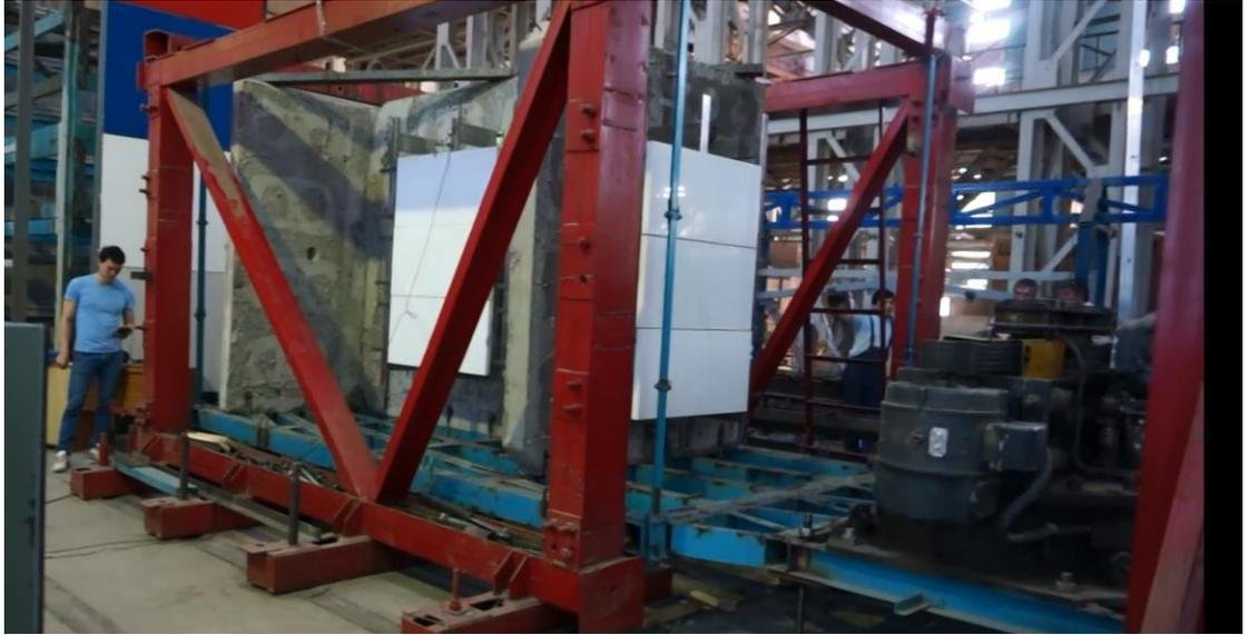
Рис. 4.3 Общий вид экспериментального стенда после установки на виброплатформу.
