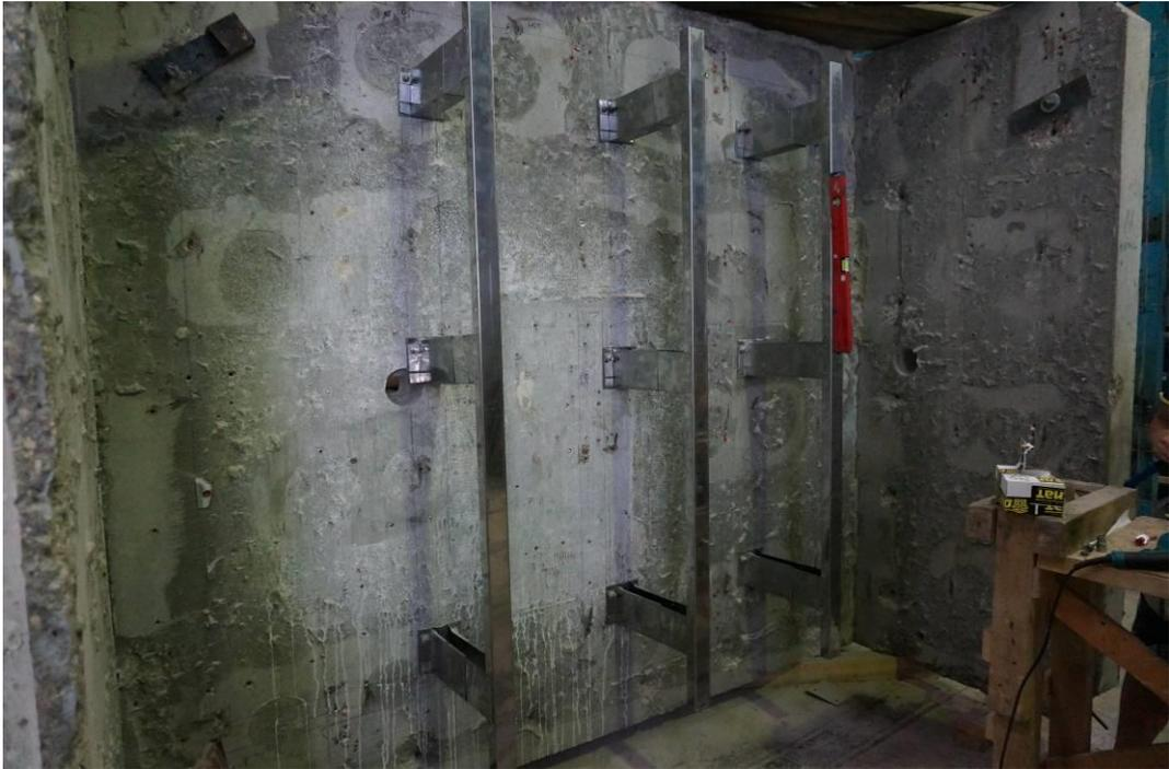
Рис. 4.1 Общий вид железобетонного стенда с закрепленными на нем несущими элементами фасадной системы.
