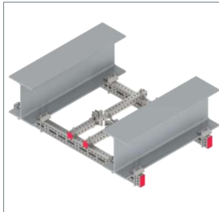
Узел фиксирующего крепления вертикального трубопровода к металлическим балкам при использовании зажима балочного
