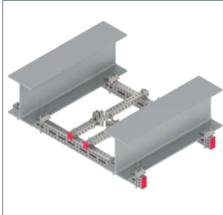
Узел фиксирующего крепления вертикального трубопровода к металлическим балкам при использовании уголка трубного ТАР 4F2
