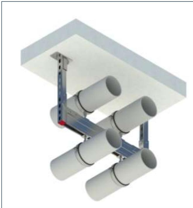
Узел крепления горизонтального трубопровода к бетонному основанию при использовании пластины опорной TBP M 4F2
