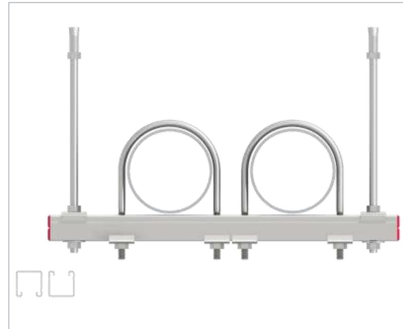
Узел крепления горизонтального трубопровода к бетонному основанию
