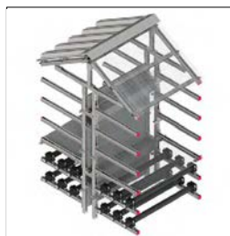
Крепление кабеля на эстакадах.
