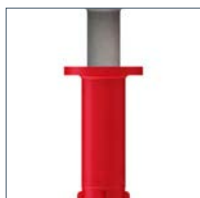
Бортик дюбеля предотвращает возникновение контактной коррозии
