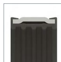
Валикообразный профиль изолирующей вставки
