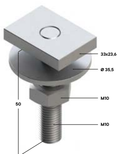
Болт Т-образный универсальный TBT U 28-40 6F
