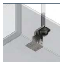
Крепление без сварки и сверления
