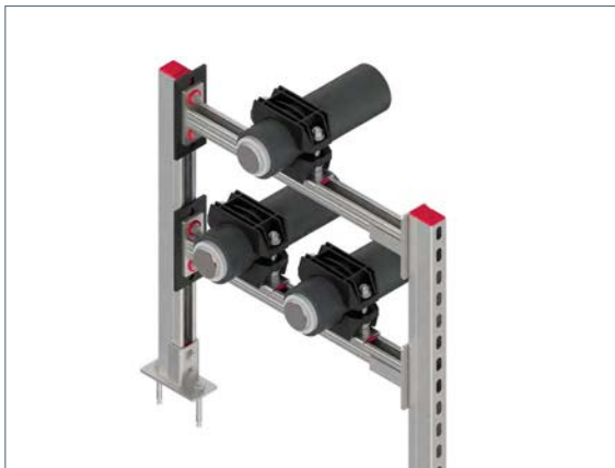
Кабельные этажи и полуэтажи. Крепление по типу «треугольник» и «в плоскости»
