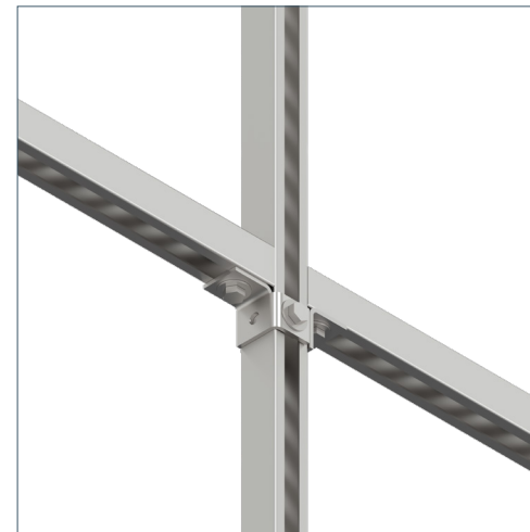
Соединение двух горизонтальных профилей со стойкой
