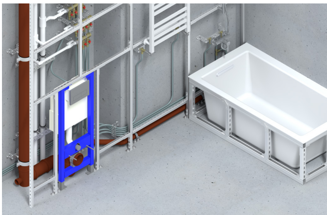
8. Крепление сантехнического оборудования и фальш-стен
