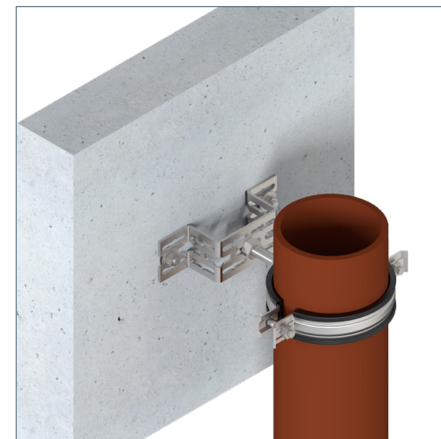
Регулировка положения смонтированного трубопровода в 3 направлениях
