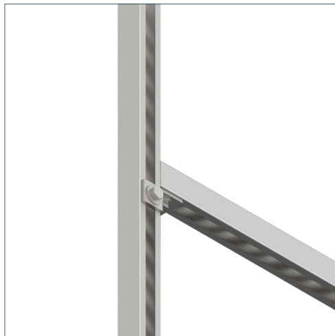
Соединение горизонтального профиля со стойкой
