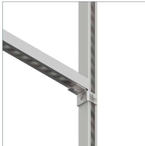
Соединение горизонтального профиля со стойкой
