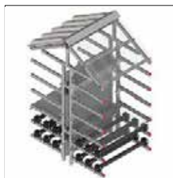
Крепление кабеля на эстакадах.
